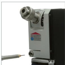
Präzise Längjustierung der Elektrode.
